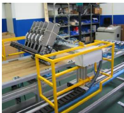
Grapado automático de paneles sandwich
