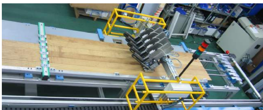
Grapado automáti- co de paneles sandwich
